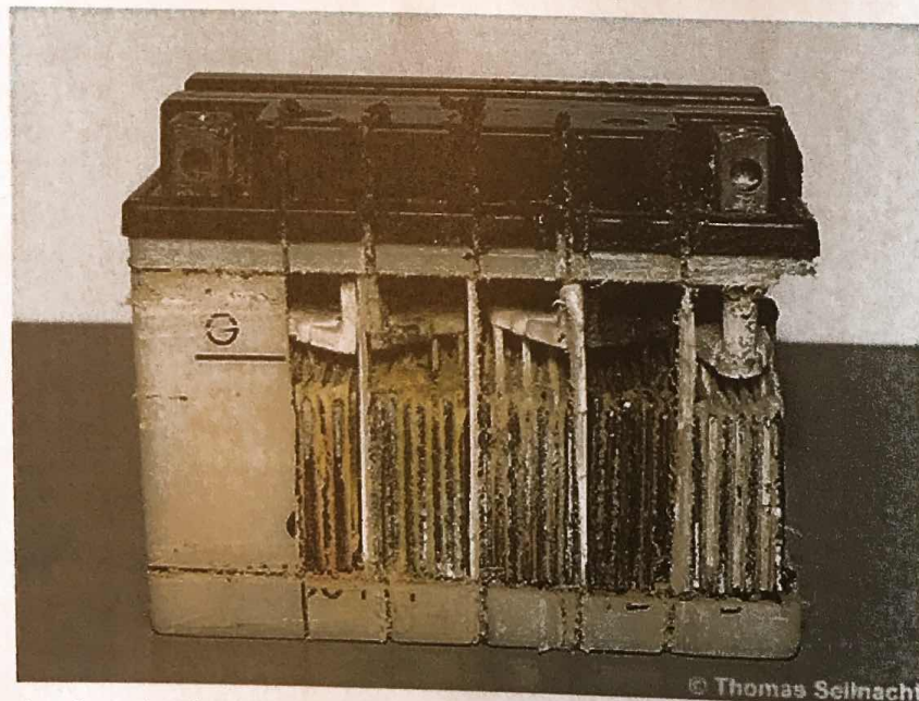
Autobatterie mit Bleisulfat-Ablagerungen (weiss)
